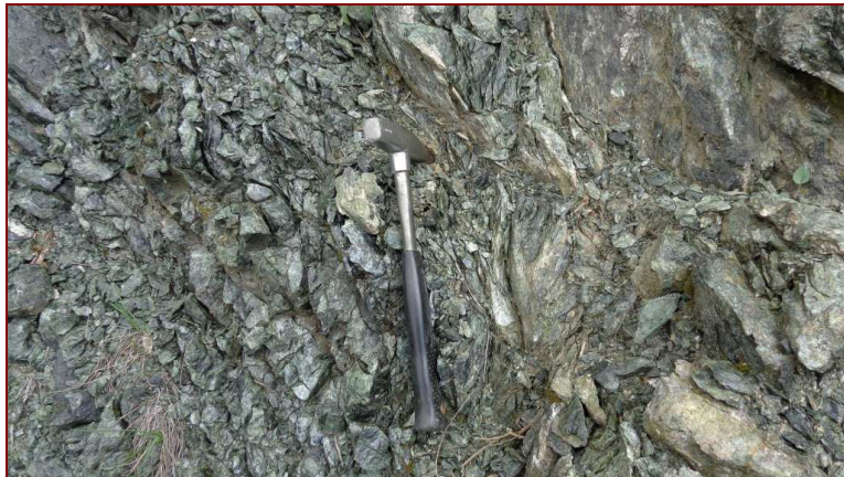
Foto n. 12 - Serpentiniti cataclastiche, con sviluppo di livelli anastomizzati foliati, di ampiezza massimo decimetrica, lungo i quali tendono a concentrarsi i minerali fibrosi
