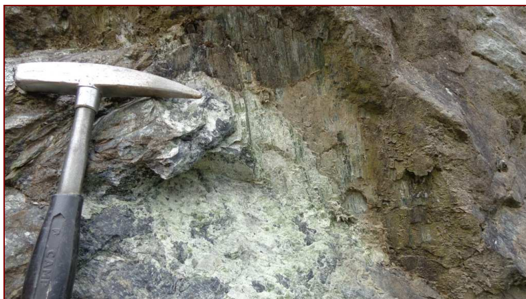
Foto n. 13 - Superficie di faglia orientata E-W (Imm./Incl. 195°/70°) con riempimento di spessore millimetrico costituito da minerali fibrosi. Slickensides lungo l'immersione
