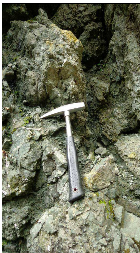
Foto n. 5 e n. 6 - Zona SR15 - Unità di Monte porzione di ammasso (metabasalti) particolarmente fratturata ed alterata, con sviluppo di cataclasi. Campione C3
