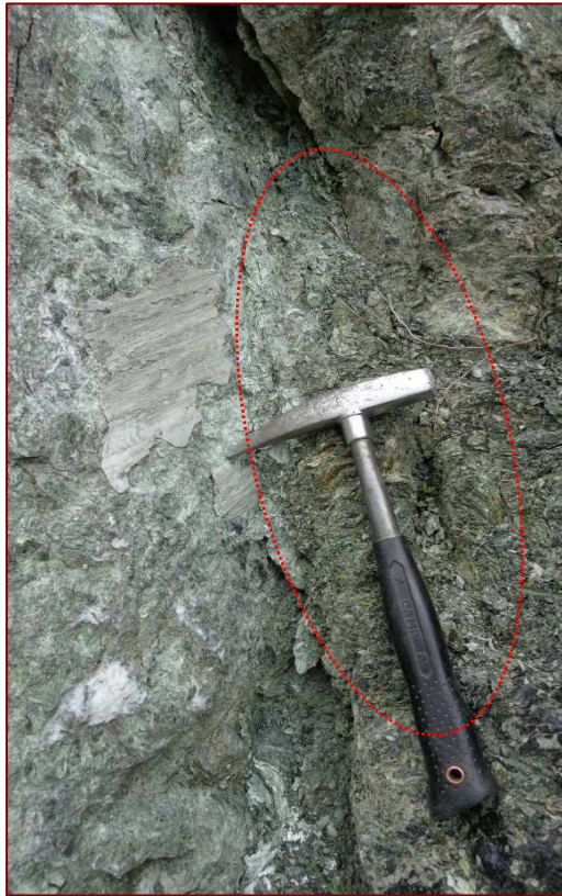
Foto n. 11- Frattura aperta orientata N-S con patina di incrostazione compatta di spessore 2-3 mm, striata. Riempimento cataclastico oggetto di campionamento. - Campione C4. Nella ripresa è evidenziata la zona del campionamento
