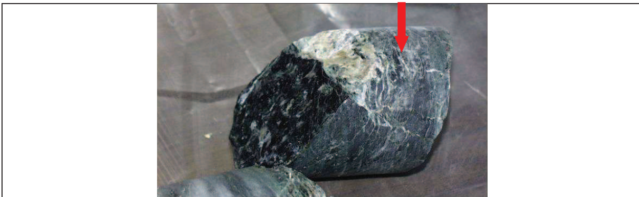
Fig. 9 - Carota di sondaggio in serpentinite. Nel punto indicato dalla freccia si ha passaggio repentino da alto tenore in amianto a tenore zero
