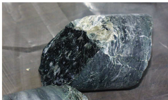
Fig. 3 - Campione di carota in serpentina compatta con spalmatura di amianto sull'esterno
