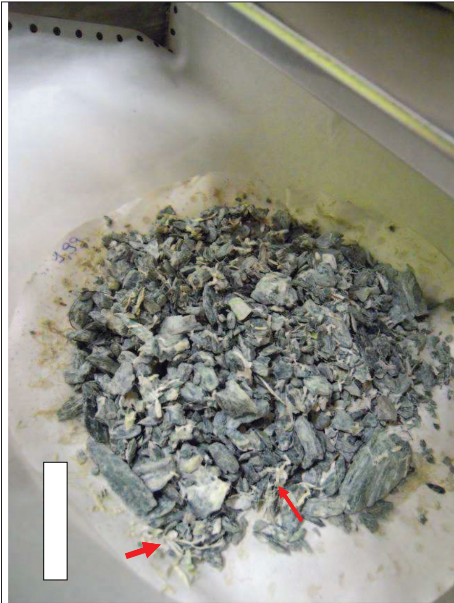
Fig. 6 – granulato derivante dalla macinazione di un campione di serpentinite asbestifera. Le frecce indicano alcuni ciuffi di crisotilo perfettamente “liberi” presenti nel granulato.
